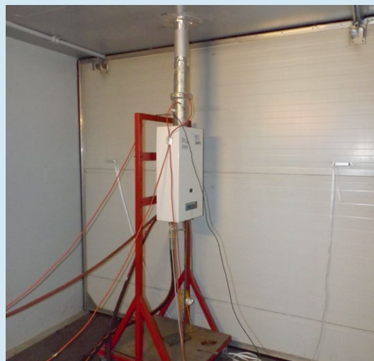
Figuur 28: Meetopstelling in verstikkingsruimte. (Bron: Kiwa)
